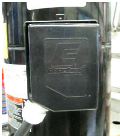
Рис. 23: Правильное электрическое подключение клеммной коробки IP21 с помощью кабельной муфты (компрессоры ZBD30K* - ZBD76K* / ZFD13KVE - ZFD25KVE)
